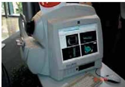
**Рис. 15. Оптический когерентный томограф**
